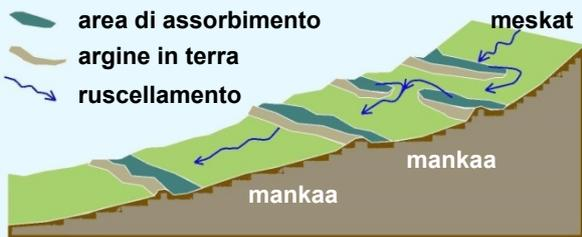
**Fig. 5.4.** Esempi schematici di tecniche per la raccolta e conservazione dell'acqua piovana sul terreno e per la protezione del suolo dall'erosione. *Fonte: Kravčík et al., 2021.*
