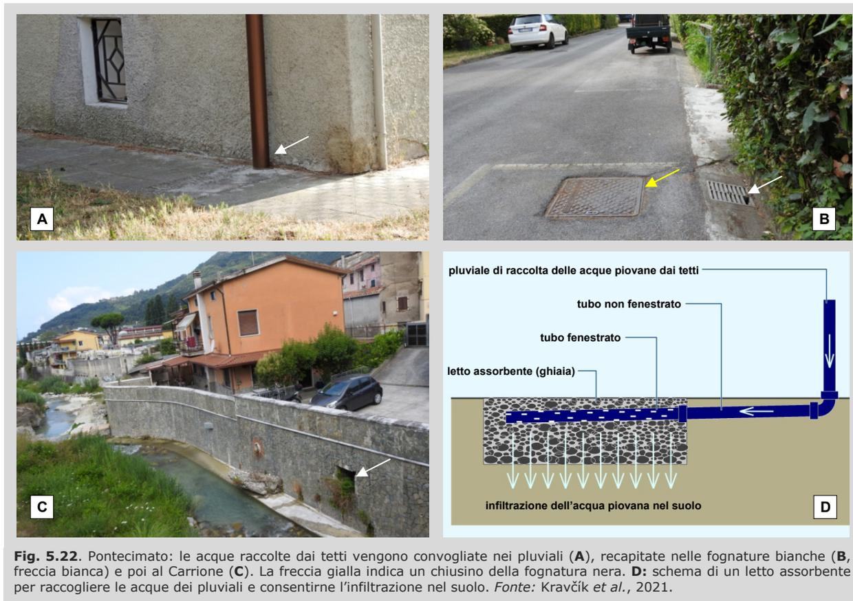
**Fig. 5.22.** Pontecimato: le acque raccolte dai tetti vengono convogliate nei pluviali (A), recapitate nelle fognature bianche (B, freccia bianca) e poi al Carrione (C). La freccia gialla indica un chiusino della fognatura nera. D: schema di un letto assorbente per raccogliere le acque dei pluviali e consentirne l'infiltrazione nel suolo. Fonte: Kravčík *et al.*, 2021.
