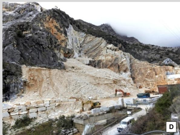
**Fig. 2.15.** **A:** vista panoramica dall'alto (Google Earth) delle cave di Gioia (in alto) e del loro ravaneto di terre (frecce). **B:** lo stesso: foto in vista frontale. **C e D:** ravaneti Polvaccio e La Madonna. Il confronto con le Fig. 2.12, 2.13 e 2.14 mostra in maniera lampante come dai vecchi ravaneti di scaglie si sia passati ai "moderni" ravaneti costituiti in netta predominanza da terre.
